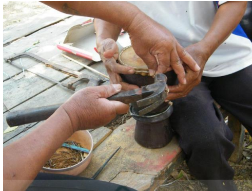
29) วิธีนำเชือกไนลอนสอดยึดหนังหน้ากลองกับเหล็ก
