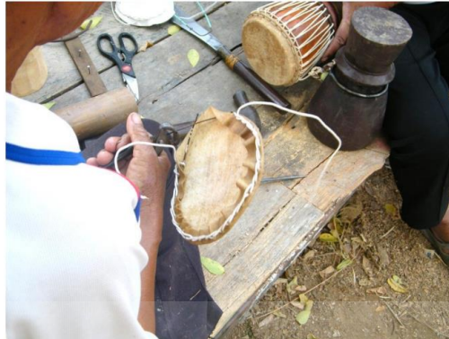
18) การทำเหล็กสำหรับยึดเชือกโยงแรงเสียง
