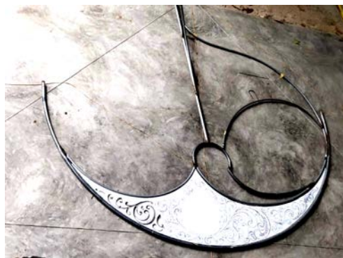
ภาพที่ 34 ร่างลวดลายบนแผ่นโฟมเพื่อแกะลวดลาย ก่อนจะนำไปหล่อพิมพ์ ที่มา : ผู้เขียน
