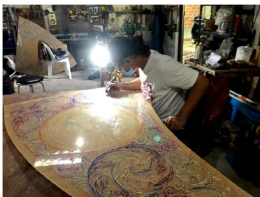
ภาพที่ 35 การกัดเซาะร่องสร้างลวดลาย ในแผ่นอะคริลิก ที่มา : ผู้เขียน
