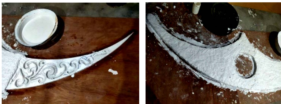
ภาพที่ 36 - 37 นำแผ่นโฟมที่แกะลวดลาย ไปหล่อพิมพ์ปูนปลาสเตอร์เพื่อทำพิมพ์ทุบ ที่มา : ผู้เขียน
