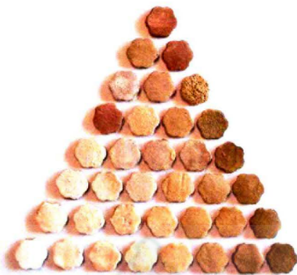
ภาพที่ 43 : ผลการเคลือบ 3 เหลี่ยม(ที่ 6)แร่หินฟันม้า,เซอร์โคเนียมซิลิเกตและดินเหนียวนครชัยศรี
