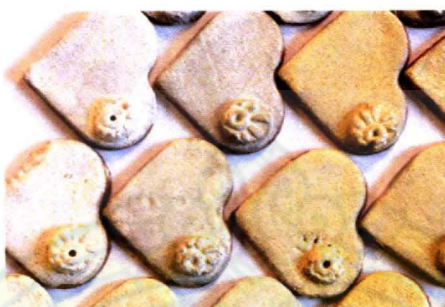
ภาพที่ 30 : รายละเอียดผลการทดลองสูตรเคลือบตาราง 3 เหลี่ยม(ที่2) 1 เคลือบแตราน ได้แก่ สูตรที่ 18,20,21,27,28,36
