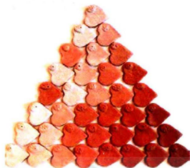
ภาพที่ 40 : ผลการเคลือบ 3 เหลี่ยม(ที่ 5)แร่หินพื้นน้ำ,ทัลค์และดินเหนียวนครชัยศรี
