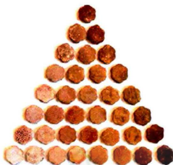
ภาพที่ 36 : ผลการเคลือบ 3 เหลี่ยม(ที่ 4)แร่หินฟันม้า,แมกนีเซียม ออกไซด์และดินเหนียวนครชัยศรี
