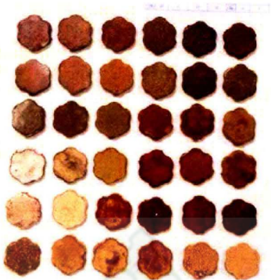
ภาพที่ 51 : ผลการทดลองเคลือบตาราง 4 เหลี่ยม (ที่ 2)แรหินพื้นม้า,แบเรียม คาร์บอเนต,แมกนีเซียม ออกไซด์และดินเหนียวนครชัยศรี
