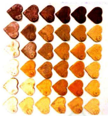
ภาพที่ 46 : ผลการทดลองเคลือบตาราง 4 เหลี่ยม (ที่ 1)แร่หินฟันม้า,แบเรียม คาร์บอเนต,ซิงค์ ออกไซด์ และดินเหนียวนครชัยศรี
