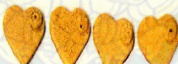
ภาพที่ 48 : รายละเอียดผลการทดลองสูตรเคลือบตาราง 4 เหลี่ยม(ที่1) 2 สูตรที่ 12 ,18,24,30 เคลือบมีการแยกตัวมีฟอง เคลือบกึ่งด้าน สีขาวครีม31-36 เคลือบด้าน ไล่ระดับขาวไปจนถึงเหลือง
