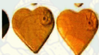
ภาพที่ 48 : รายละเอียดผลการทดลองสูตรเคลือบตาราง 4 เหลี่ยม(ที่1) 2 สูตรที่ 12 ,18,24,30 เคลือบมีการแยกตัวมีฟอง เคลือบกึ่งด้าน สีขาวครีม31-36 เคลือบด้าน ไล่ระดับขาวไปจนถึงเหลือง
