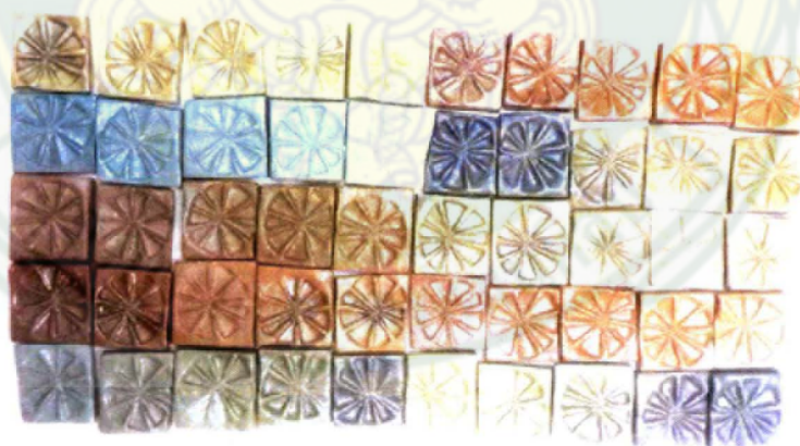
ภาพที่ 65 : ผลการทดลองเคลือบที่บดเต็มสารให้สีสูตรตาราง 4 เหลี่ยม (1) สูตรที่ 11
