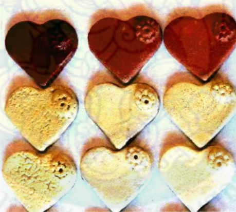
ภาพที่ 58 : รายละเอียดผลการทดลองสูตรเคลือบตาราง 4 เหลี่ยม(ที่4) 2
