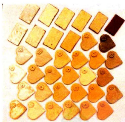
ภาพที่ 54 : ผลการทดลองเคลือบตาราง 4 เหลี่ยม (ที่ 3) แร่หินฟันม้า, ซิงค์ ออกไซด์, ทัลค์ และดินเหนียว นครชัยศรี
