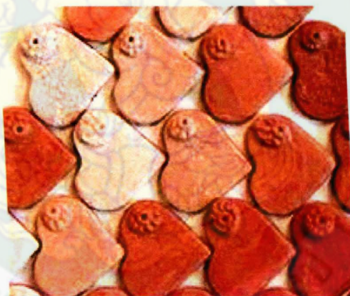
ภาพที่ 42 : รายละเอียดผลการทดลองสูตรเคลือบตาราง 3 เหลี่ยม(ที่5) 2
