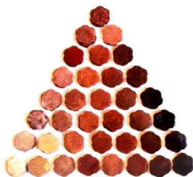
ภาพที่ 26 : ผลการทดลองเคลือบตาราง 3 เหลี่ยม(ที่1)แร่หินฟันม้า,แบเรียม และดินเหนียวนครชัยศรี
