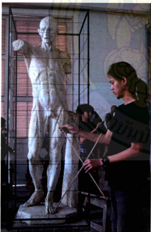
ภาพที่ 49 ภาพเครื่องมือลำดับที่ 3 วงเวียนย่อขยายส่วน 1:2 เมื่อใช้ย่อสัดส่วนในงานประติมากรรม โดยใช้ปลายด้านยาววัดขนาดแบบที่ต้องการ แล้วใช้ปลายด้านสั้น วัดขนาดสัดส่วนในการย่อลงครึ่งเท่า ที่มา ผู้วิจัย
