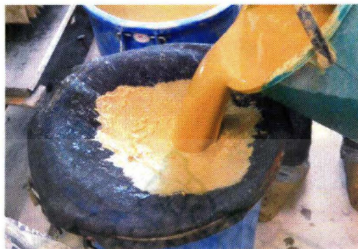
ภาพที่ 35 : ขั้นตอนการเทน้ำดินผ่านตะแกรง
