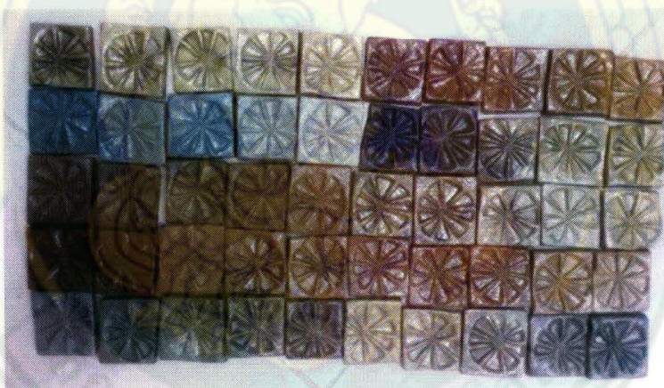
ภาพที่ 43: ผลการทดลองเคลือบที่บดเติมสารให้สีสูตรตาราง 4 เหลี่ยม
