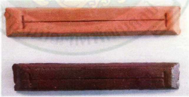
ภาพที่ 29 : ดินเหนียวนครชัยศรีหลังเผาที่อุณหภูมิ 1200 องศาเซลเซียส
