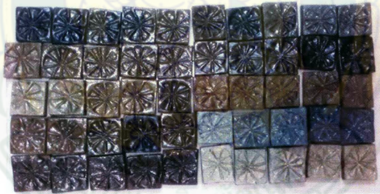
ภาพที่ 41 : ผลการทดลองเคลือบใสเดิมสารให้สีสูตรตาราง 3 เหลี่ยม
