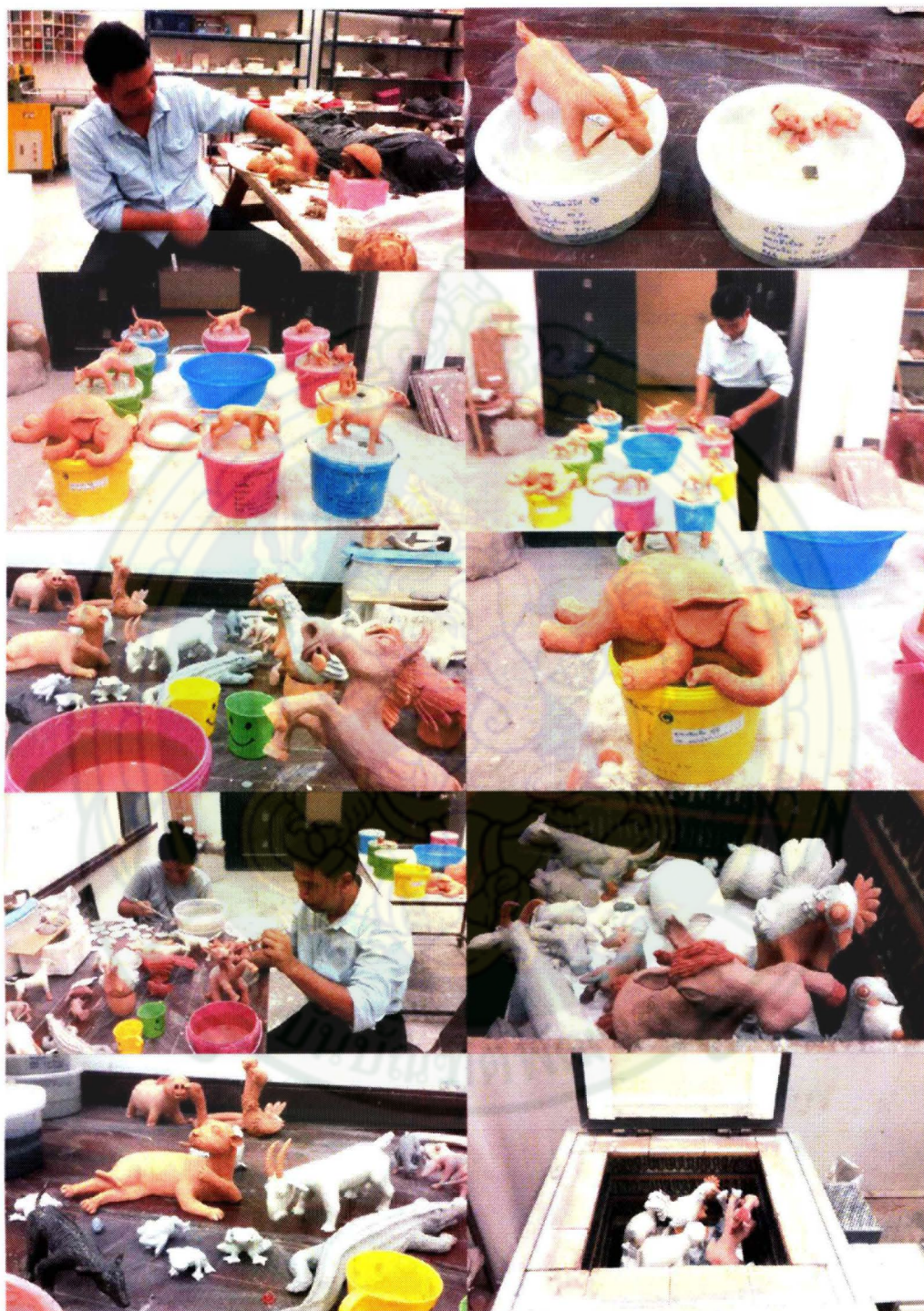
ประมวลภาพขั้นตอนการปฏิบัติงานการเคลือบชิ้นงานก่อนนำไปเผา
