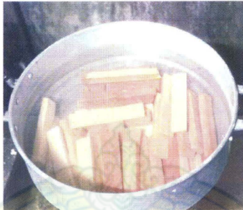
ภาพที่ 6 : การต้มแห้งดินเพื่อหาค่าการดูดซึมน้ำ
