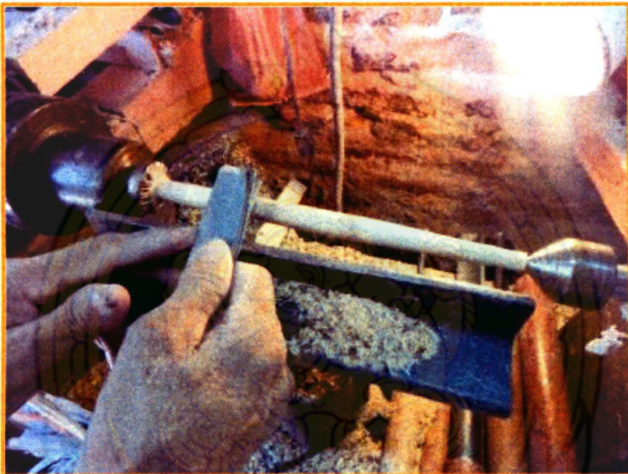
ภาพที่ 14 การขัดก้ามไม้ด้วยกระดาษทรายหยาบ (เบอร์ 3)
