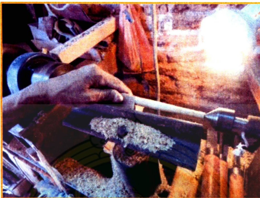
ภาพที่ 15 การขัดก้านไม้ด้วยกระดาดทรายละเอียด (เบอร์ 0)
