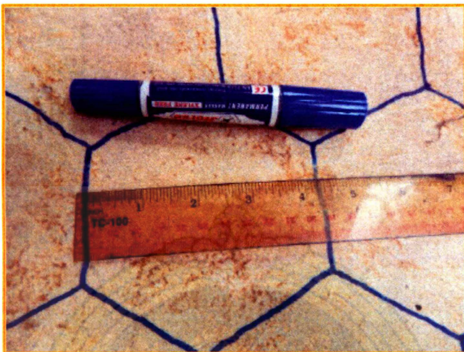
ภาพที่ 24 การขีดเส้นเพื่อเป็นเครื่องหมายในการตัดตามรอยที่ขีดเส้นไว้ ที่มา : ผู้วิจัย
