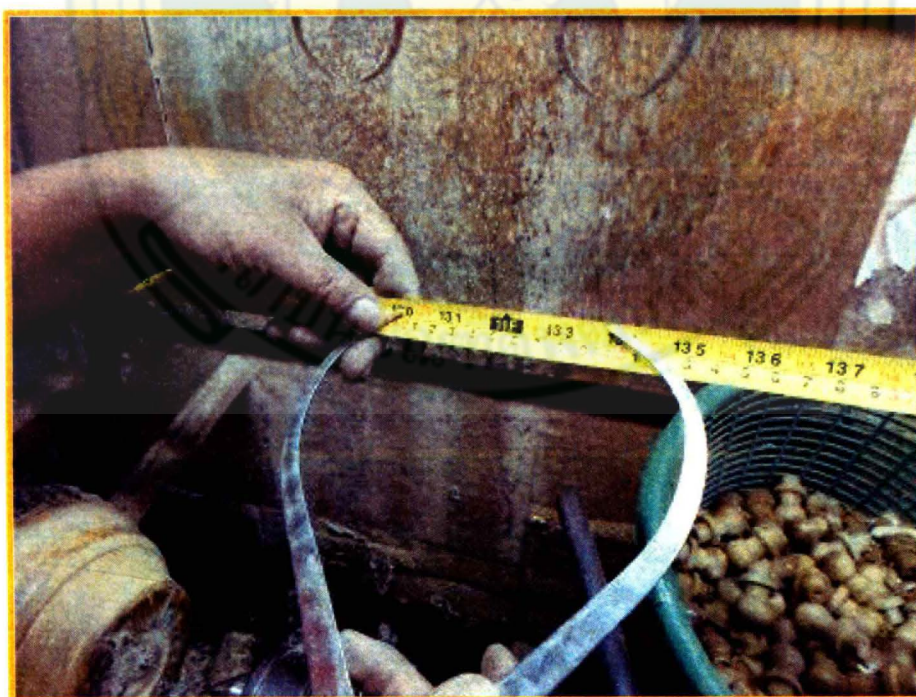
ภาพที่ 33 การใช้อุปกรณ์ “เขาควย” เพื่อกำหนดความใหญ่ของแผ่นหนัง ที่มา : ผู้วิจัย
