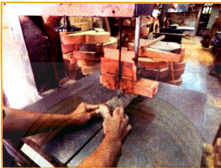
ภาพที่ 5 การซอยไม้ด้วยเลื่อยสายพาน ที่มา : ผู้วิจัย
