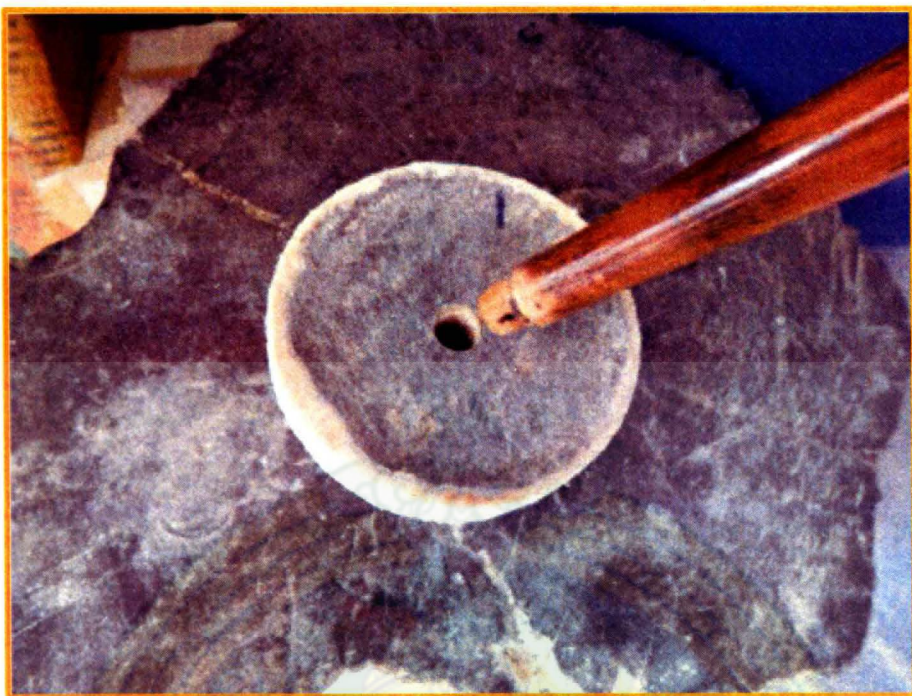
ภาพที่ 42 การประกอบหนังและก้านไม้เข้าด้วยกัน ที่มา : ผู้วิจัย
