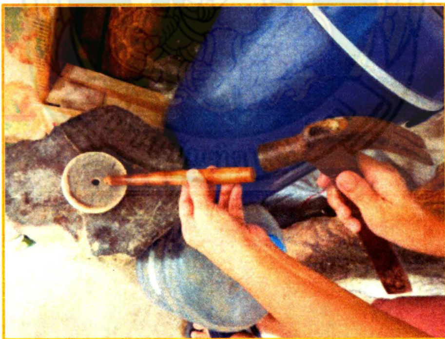
ภาพที่ 43 การเสียบก้านเข้ากับหนังที่เจาะรูไว้โดยใช้ค้อนตอก ที่มา : ผู้วิจัย
