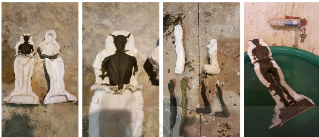
ภาพที่ 177 กระบวนการหล่อชิ้นงานเป็นขี้ผึ้งชั้น ต้มขี้ผึ้งให้ละลายแล้วเทลงแม่พิมพ์แล้วนำลงไปแช่น้ำเพื่อลดความร้อนของขี้ผึ้งเพื่อให้ชิ้นงานแข็งตัว
