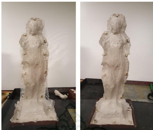
ภาพที่ 170 การตกแต่งขอบยางแม่พิมพ์
