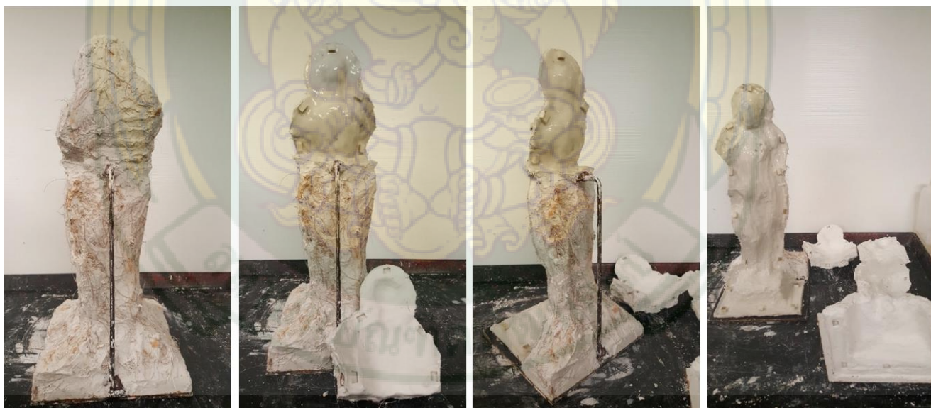
ภาพที่ 174 แกะแม่พิมพ์ปูนออกจากต้นแบบ
