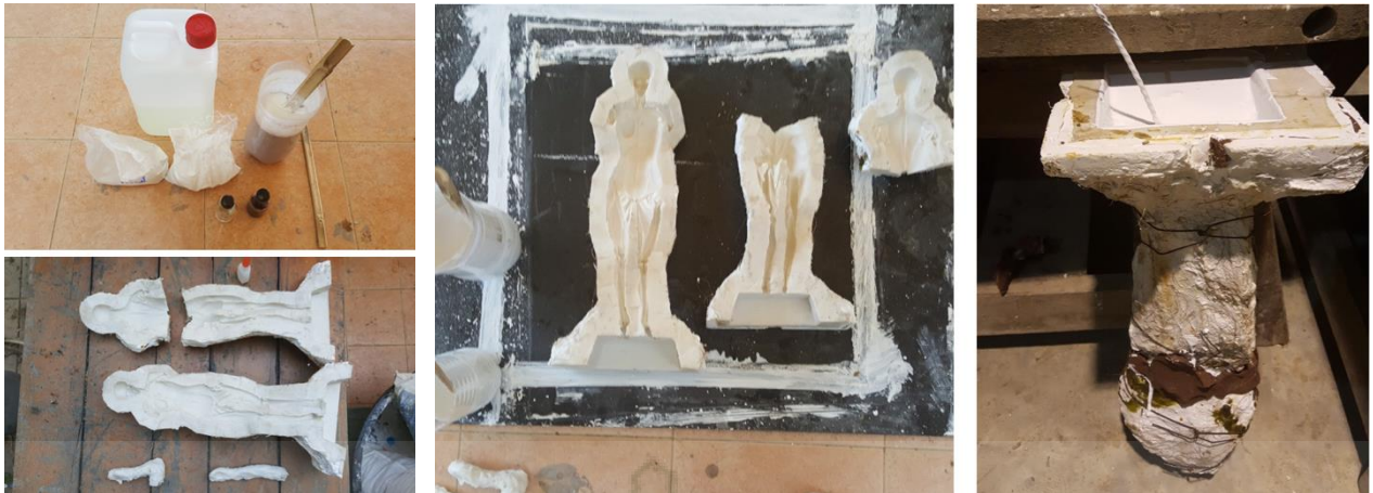
ภาพที่ 185 กระบวนการหล่อชิ้นงานเป็นวัสดุเรซิน
