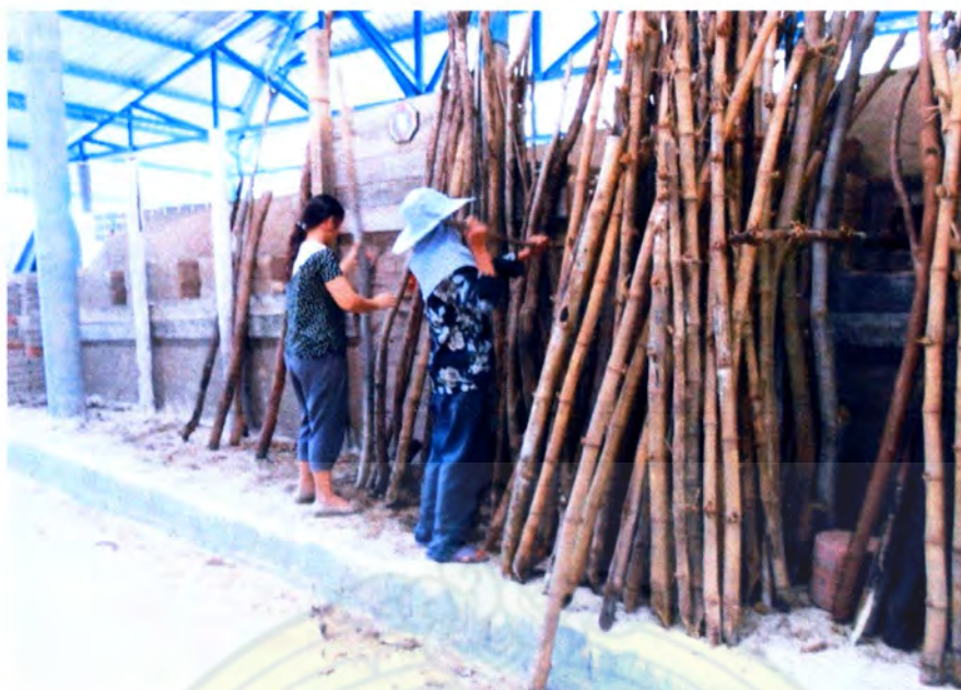
ภาพที่ ๖๘ การใส่ฟืน ตามช่องลมสังเกตสีของเครื่องปั้นดินเผาเพื่อลดและเพิ่มปริมาณฟืน
