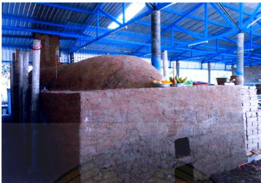
ภาพที่ ๖๖ เตาเผารูปทรงจรวด โดยใช้ฟืนมีช่องลมหน้าเตา ๒ ช่อง และด้านข้าง ด้านละ ๕ ช่อง
