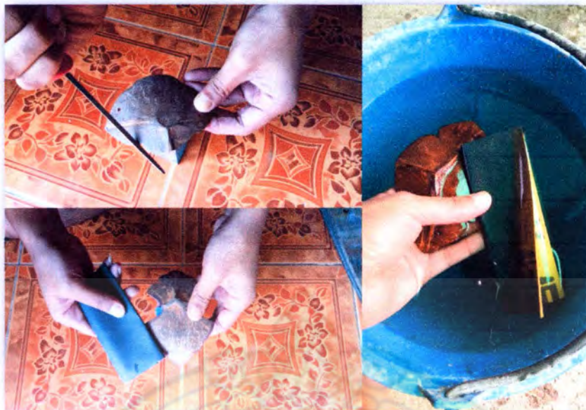
ภาพที่ 137 การขัดเครื่องประดับให้ผิวเรียบเนียน และการลงแลคเกอร์เครื่องประดับให้เกิดความเงางาม
