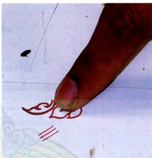
ภาพที่ 66 ภาพการทดสอบความคงทนโดยการทดลองใช้นิ้วถู ว่าสีอ่อนขาวหรือไม่
