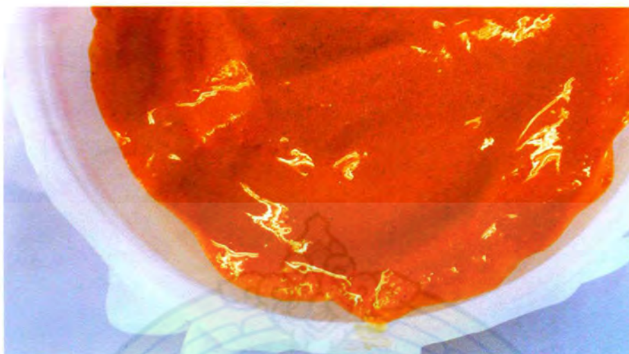
ภาพที่ 23 ภาพเม็คสีที่หยาบ จะค้างอยู่บนผ้า ในขณะที่เม็คสีที่ละเอียดจะไหลผ่านลงในภาชนะ
