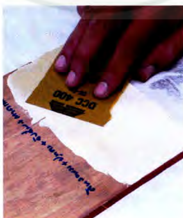
ภาพที่ 144 ภาพการฉาบ และขัดผิวด้วยกระดาษทรายเบอร์ 400 และ 1000
