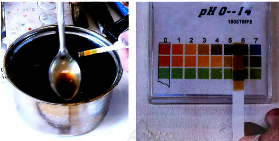
ภาพที่ 70 ภาพค่า PH ของกาวจากหนังสัตว์ ค่าเท่ากับ 5.5
