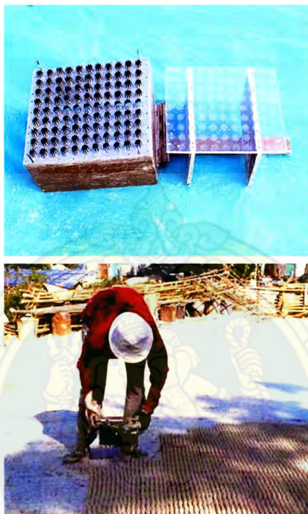
ภาพที่ 24 บนภาพเครื่องมือที่ใช้กดดินสอพองให้มีลักษณะเป็นเม็ดกลมขอดีกลม ล่างการผลิตดินสอพองแบบที่ใช้ทำแป้งกระแจะ
