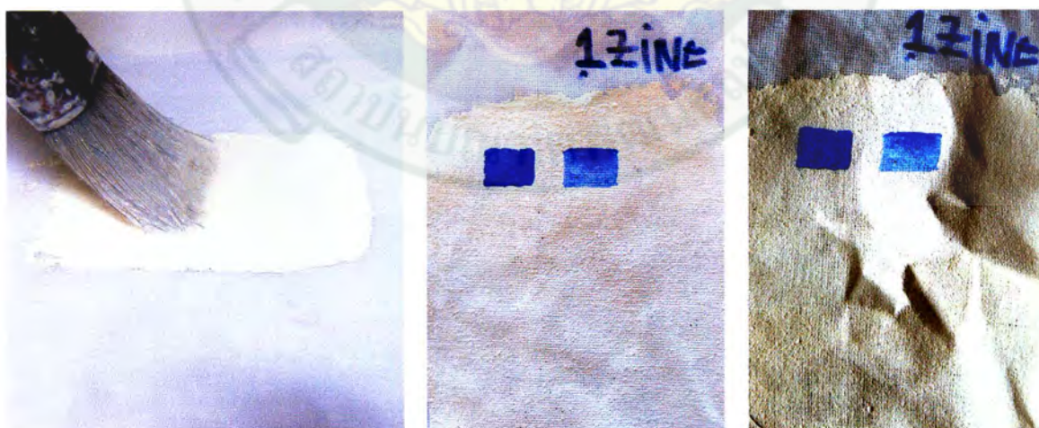
ภาพที่ 155 ภาพการทาสมุกบนผ้า และเมื่อสมุกแห้งแล้วทดลองขยี้ผ้า สมุกจะไม่เกิดการแตกร้าว และยืดหยุ่นดี
