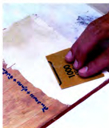
ภาพที่ 144 ภาพการฉาบ และขัดผิวด้วยกระดาษทรายเบอร์ 400 และ 1000
