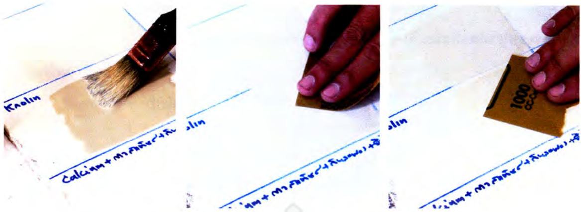
ภาพที่ 142 ภาพการทาสมุท และการขัดผิวด้วยกระดาษทรายเบอร์ 400 และ 1000
