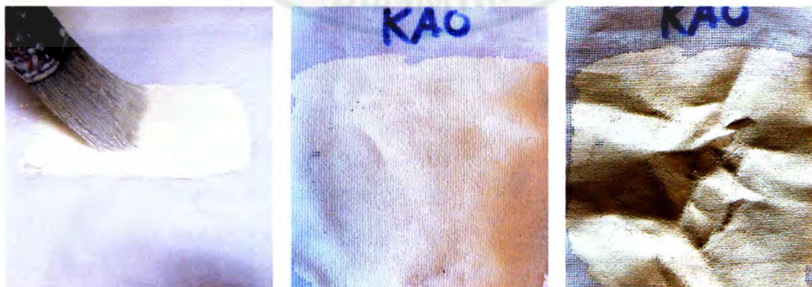
ภาพที่ 161 ภาพการทาสมุกบนผ้า และเมื่อสมุกแห้งแล้วทดลองขยี้ผ้า สมุกเกิดการแตกร้าวขึ้นบางส่วน
