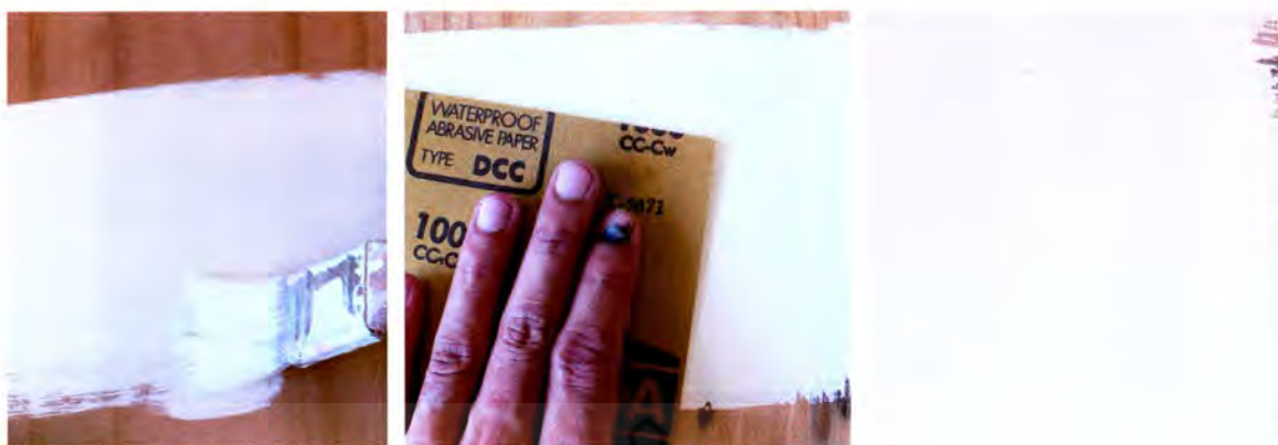
ภาพที่ 149 ภาพการทำสมุก และภาพตัวอย่างการทดลองที่เสร็จแล้ว
