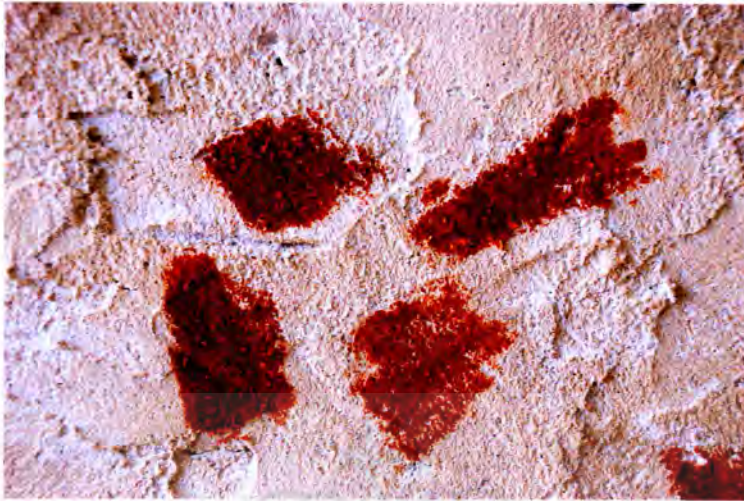
ภาคผนวก ก ที่ 1 ภาพการทดสอบความเป็นต่างของผนังปูน
