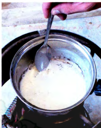
ภาพที่ 115 ภาพการต้มแป้งข้าวเจ้ากับน้ำปูนขาว
