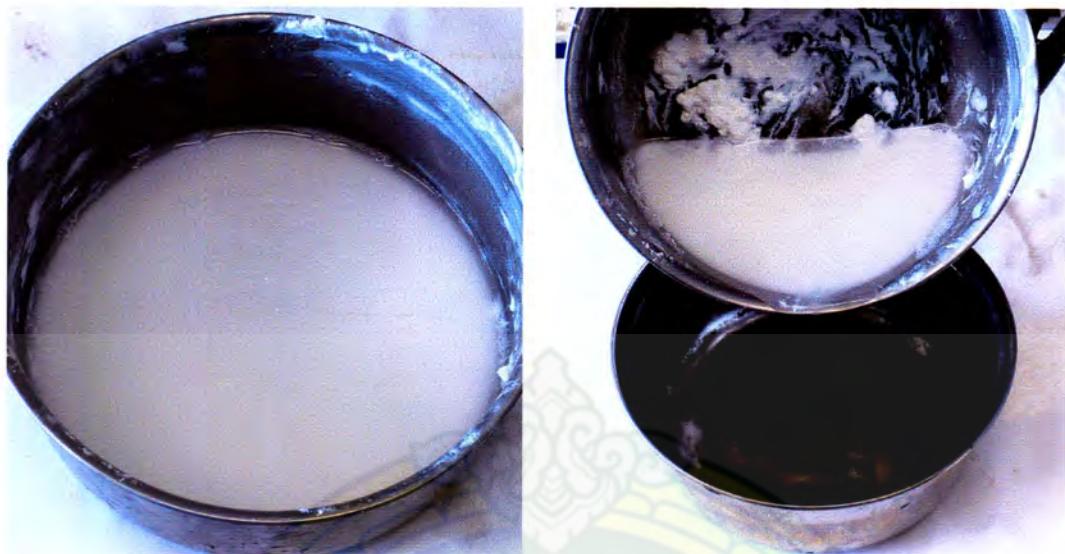
ภาพที่ 51 ภาพการรินเอาแต่น้ำปูนใส สำหรับผสมสมุก
