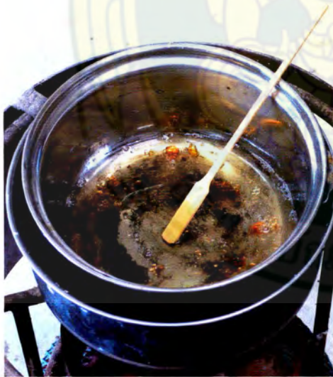
ภาพที่ 77 ภาพการต้ม และกรองกาวกระถิน
