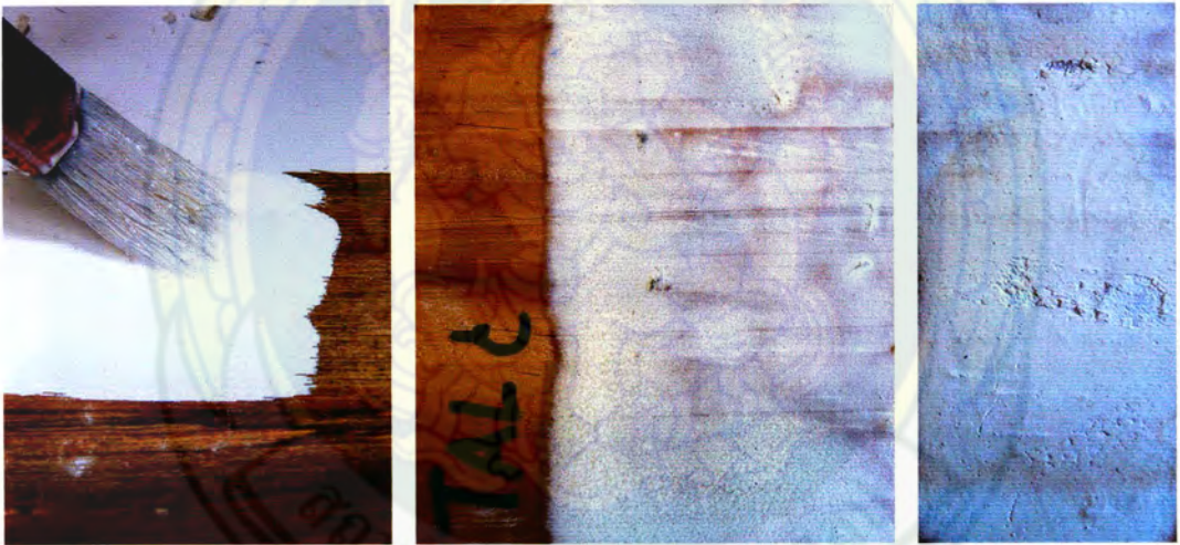
ภาพที่ 151 ภาพการทาสมุก และภาพตัวอย่างการทดลองที่เสร็จแล้ว
