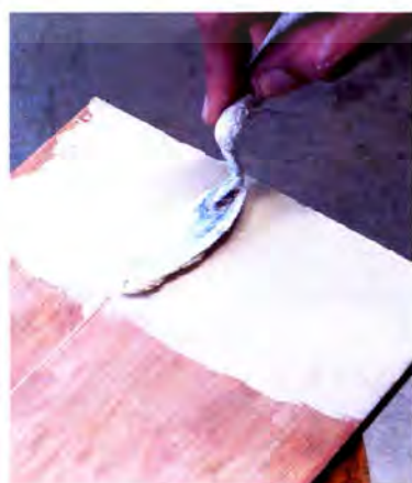
ภาพที่ 144 ภาพการฉาบ และขัดผิวด้วยกระดาษทรายเบอร์ 400 และ 1000
