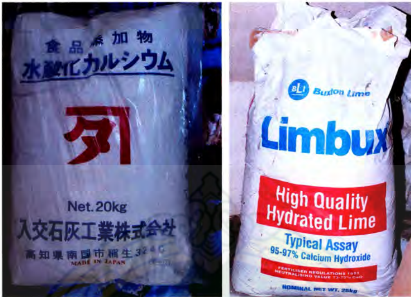
ภาพที่ 20 (ซ้าย) ปูนขาว Calcium hydroxide จากประเทศญี่ปุ่น (ขวา) ปูนขาว Calcium hydroxide จากประเทศอังกฤษ
