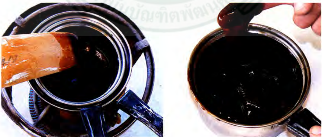
ภาพที่ 69 ภาพการเตรียมกาวจากหนังสัตว์
