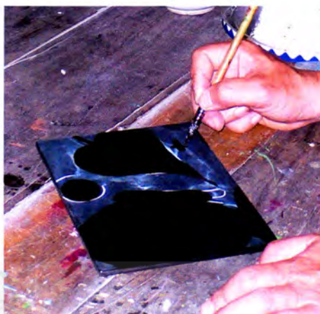
ภาพที่ 112 ภาพการผสมรักไต แล้วทารักที่ผสมแล้วลงบนพื้นที่ที่จะปิดแผ่นเงินให้ทั่ว
