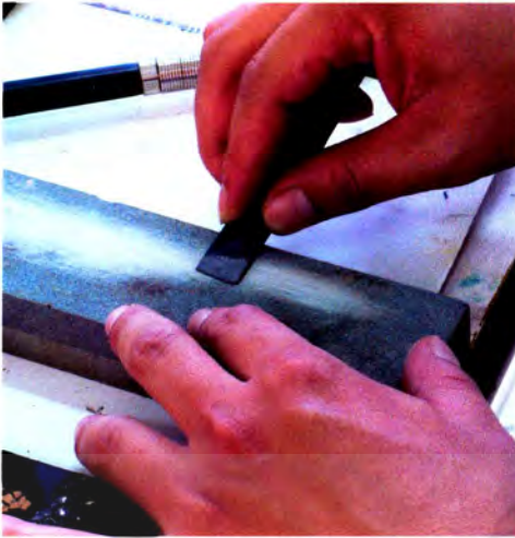
ภาพที่ 68 ภาพการฝนแต่งให้พายเป็นความสมบูรณ์พร้อมใช้งาน
