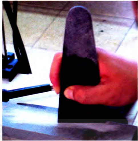
ภาพที่ 68 ภาพการฝนแต่งให้พายเป็นความสมบูรณ์พร้อมใช้งาน
