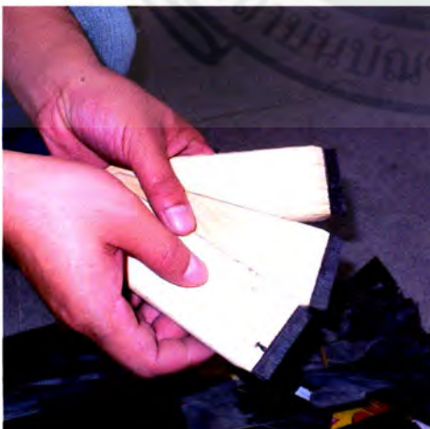
ภาพที่ 69 ภาพการเลือกแปรง ให้เลือกปลายเสมอกัน ด้ามตรงได้รูป
