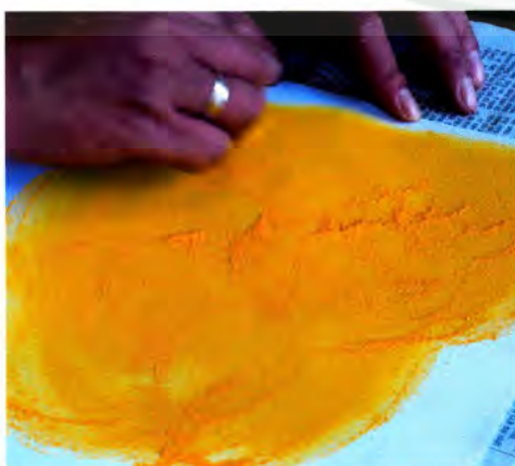
ภาพที่ 83 ภาพการถ่ายแบบลงบนชิ้นงาน
