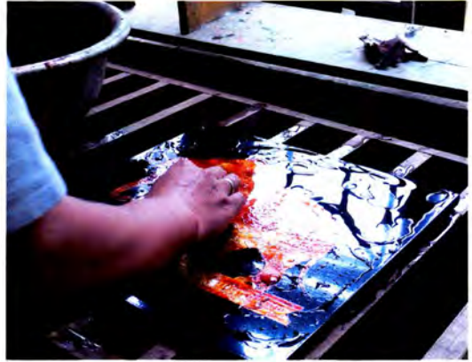
ภาพที่ 128 ภาพกระบวนการขัดให้เกิดภาพ Sanding Process
