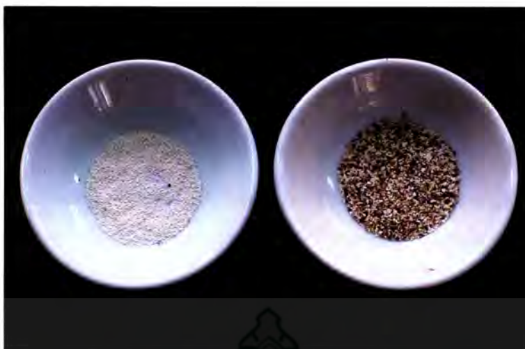
ภาพที่ 52 ภาพเปลือกไข่บด เป็นจีนละเอียด และหยาบปานกลาง
