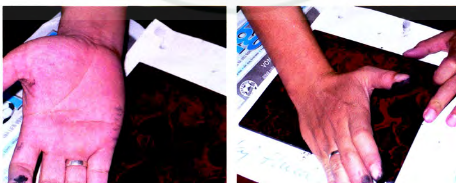
ภาพที่ 136 ภาพการใช้ฝ่ามือ ถูเป็นวงกลมลงบนชิ้นงานให้ทั่ว
