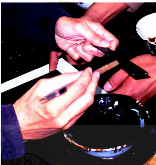
ภาพที่ 161 ภาพการเคลือบรักใส โดยการถอนรักออกให้เหลือบางที่สุดโดยปาดรักออกกับพาย
