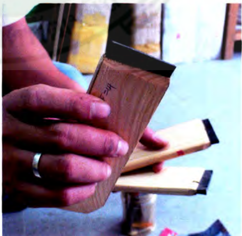
ภาพที่ 69 ภาพการเลือกแปรง ให้เลือกปลายเสมอกัน ด้ามตรงได้รูป
