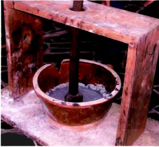
ภาพที่ 27 ภาพภาชนะไม้ และไม้พายที่ใช้ในการกวนรักไส (ซ้าย) ภาชนะเหล็ก และไม้พายเหล็ก ที่ใช้ในการกวนรักดำ (ขวา)
