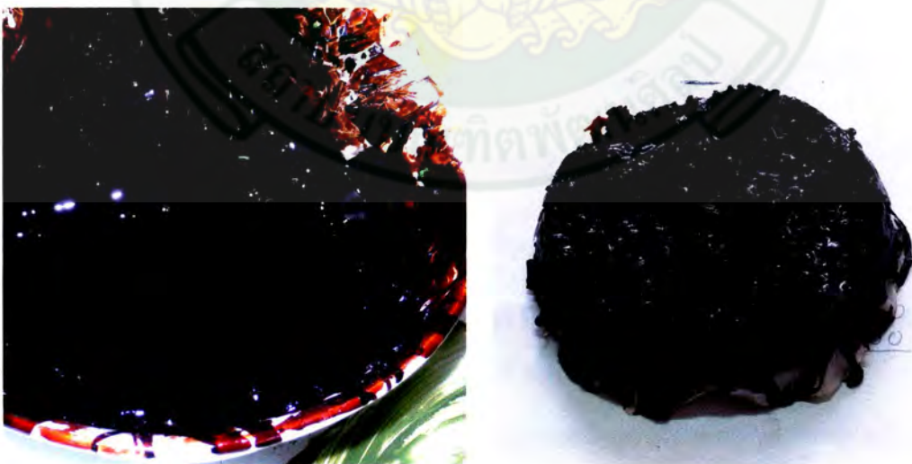
ภาพที่ 38 ภาพตัวอย่างรักที่แห้งติดกระดาะไข และสูญเสียรักจำนวนมาก เนื่องจากไม่ระวังในการเก็บรักษา
