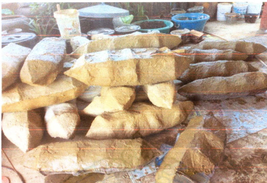
ภาพที่ 35 ปูนฉาบทับตะแกรงลวดหุ้มให้เป็นเม็ดยาว
