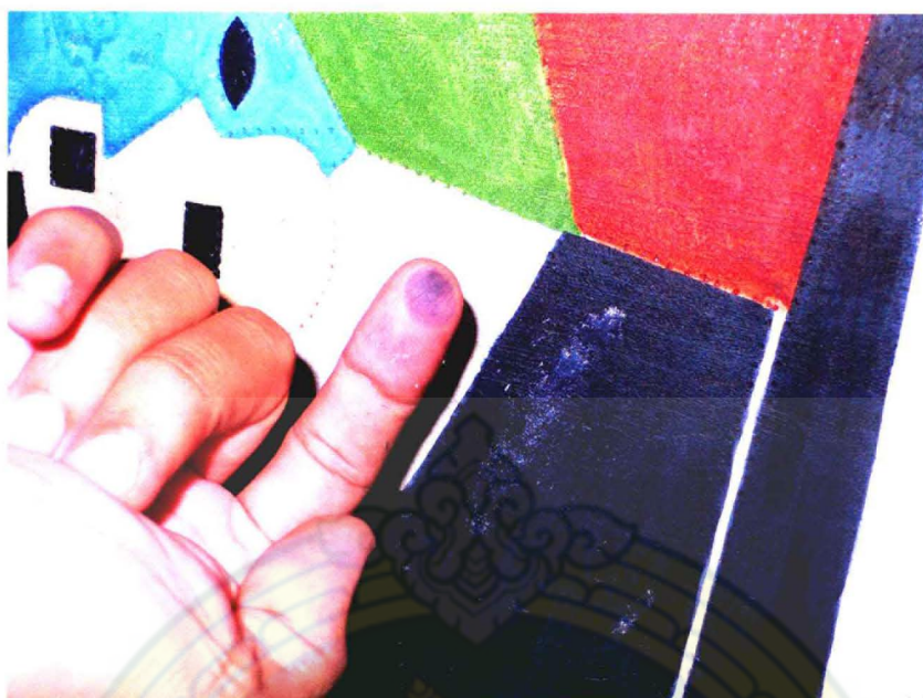
ภาพที่ 99 ภาพแสดงการทดสอบการขีดขีด เมื่อเอานิ้วปากบนสี มีสีถลอก พื้นที่สีดำ
