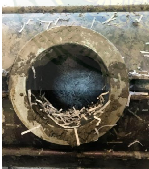
ภาพที่ 23 : นำเศษกระดาษใส่ลงในหม้อบด (Ball mill) ที่มา : อำนวย นวลอนงค์
