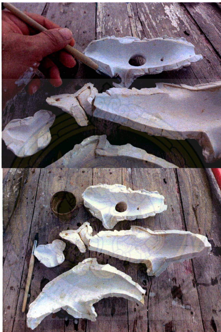
ภาพที่ 26 : ตกแต่งพิมพ์ทุบเพื่อเตรียมหล่อต้นแบบปูนพลาสติกอร์
