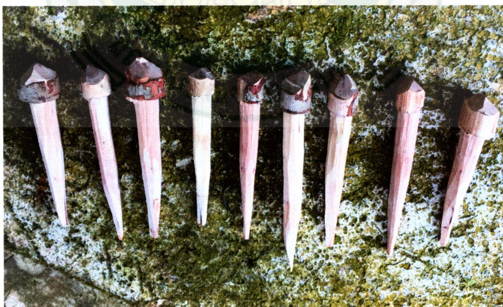
ภาพที่ 34 ภาพแสดงการนำลูกสักไปตากแดดให้แห้ง
